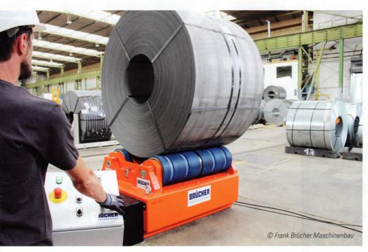
Eine mobile Coilvorbereitungsstation von Frank Brücher sorgt für höchste Flexibilität im Handling von Coils und spart erhebliche Fahrwege für die Krananlagen.
